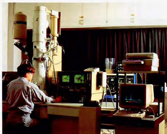
透過型電子顕微鏡による触媒の研究 (株)コスモ総研・研究開発センター（埼玉県幸手市）
