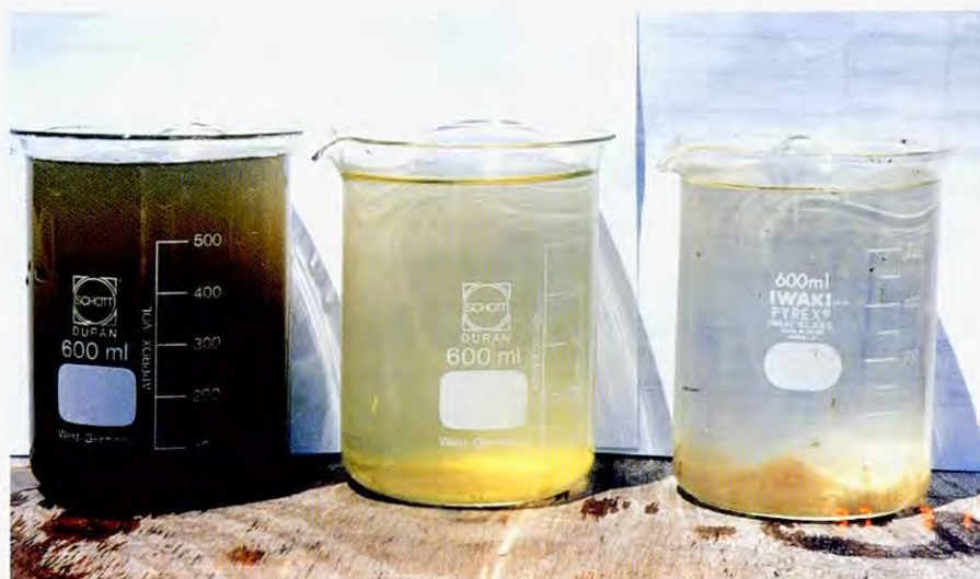
原水入口 ばっ気槽出口 凝集沈殿槽出口
