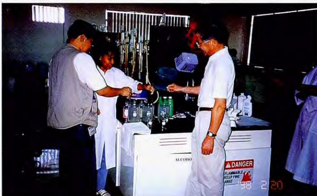
工場排水の凝集分離実験
