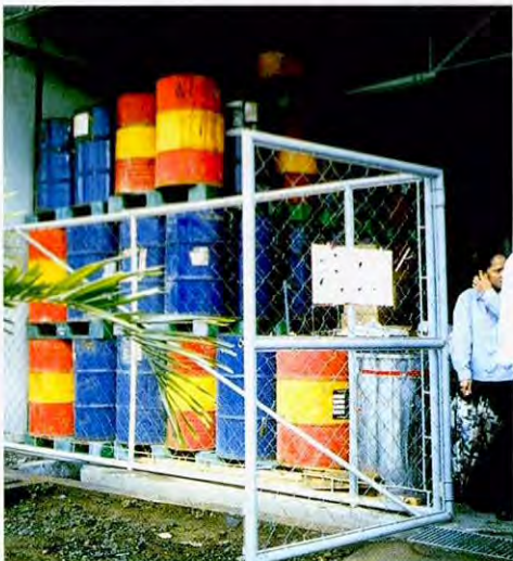
屋根付倉庫で保管されている液体有害廃棄物
