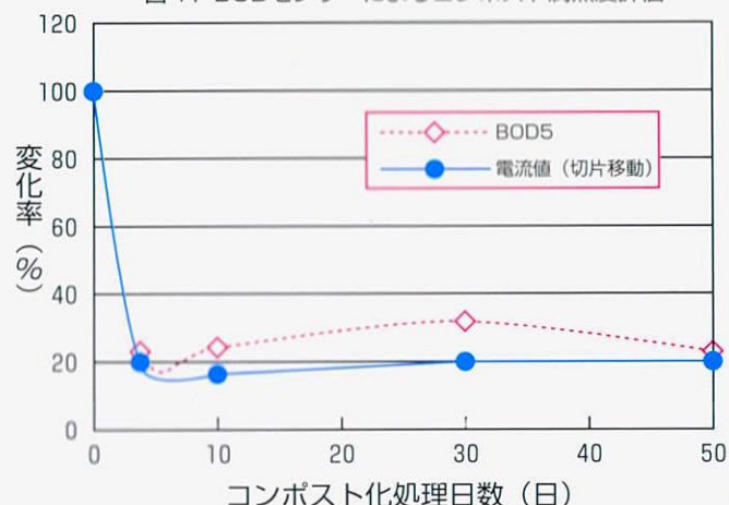
図4. BODセンサーによるコンポスト腐熟度評価
