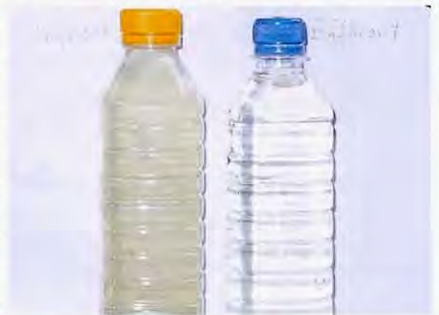
(写真1) 原水(流入水)と処理水の比較
