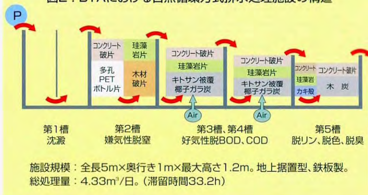
図2: BTAにおける自然循環方式排水処理施設の構造
